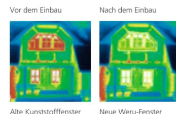
**Wärmebildaufnahmen:** Rot zeigt die Wärmeverlustbereiche. Je stärker die rote Farbe, umso höher ist der Wärmeverlust an den einzelnen Bauteilen.
