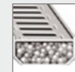
**Edelstahlabstandhalter** bestehen aus besser wärmedämmendem Material mit einem längenbezogenen Wärmedurchgangskoeffizienten von 0,048 W/(mK) bei 3-Scheiben-Wärmeschutzverglasung. Dadurch wird das Risiko der Kondenswasserbildung oberhalb der Glasleiste minimiert.
