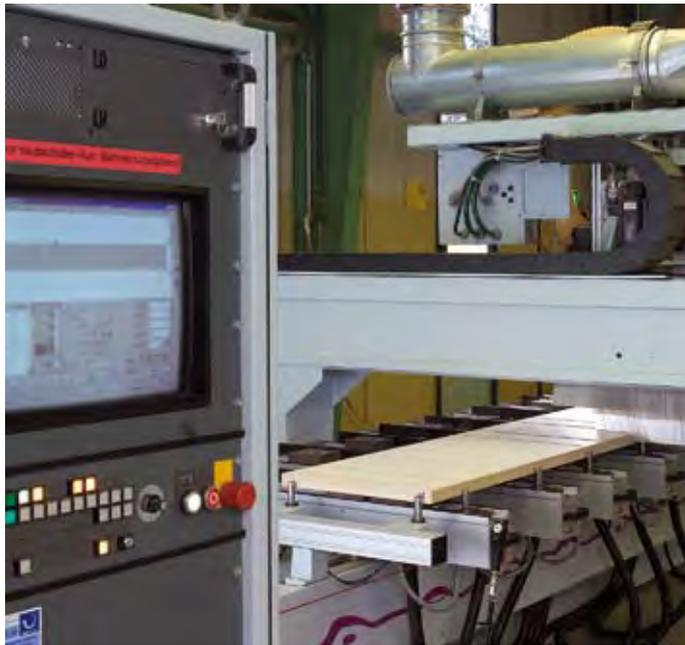
Eine computergesteuerte Präzisions-Fräse überträgt Ihren Entwurf punktgenau in die Holzpaneele des Tores.
