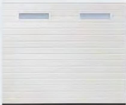
Für alle Tortypen und Nebentüren mit Sicken-Optik, in den Oberflächen Woodgrain und Decograin. Verglasungsrahmen: Kunststoff in Schwarz, Weiß oder auf Wunsch in Torfarbe. Verglasung: Je nach Tortyp als Einfach- oder Doppelscheiben aus Kunststoff, klar oder Kristallstruktur. Lichte Durchsicht: 602 x 132 mm.
