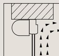
Der vorgebaute ALUKON-Rolladen liegt außerhalb des Fensters und vermeidet so Wärmeverluste.
